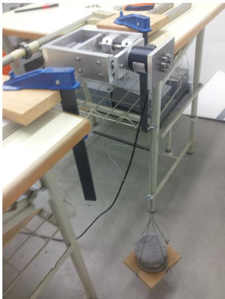
Figura 3.2: Montaje para la calibración de la Célula de Torque
