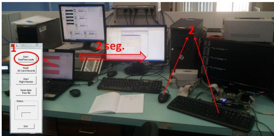
Figura 3.35: Esquema del modo de inicio de la captura de datos.
