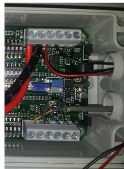
Figura 2.60: Conexionado de los cables del Sensor de Par.
