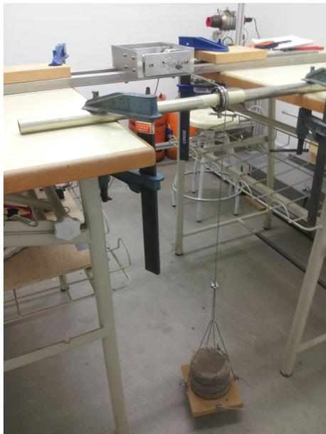
Figura 3.1: Montaje para la calibración de la Célula de Fuerza
