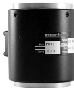
Figura 2.39: Célula de Torque.
