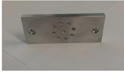
Figura 2.35: Fotografía de la Galleta de Torque.
