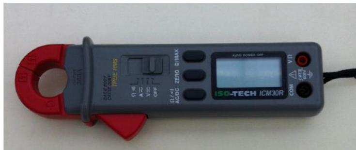
Figura 3.10: Medidor de Intensidad y Voltaje
