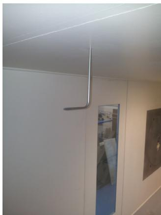
Figura 3.21: Sonda de Pitot
