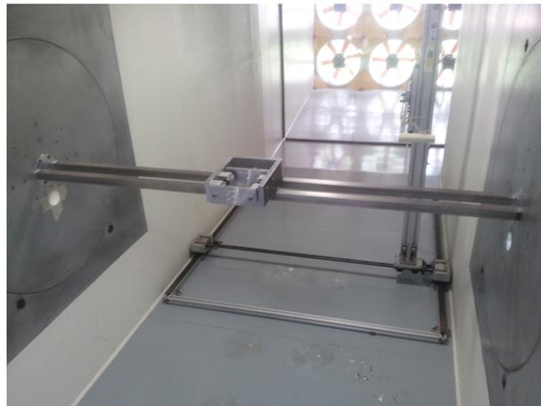
Figura 2.42: Prueba de montaje en Túnel de Viento.
