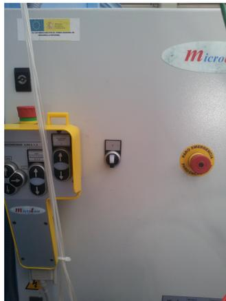
Figura 3.15: Interruptor de energizado de motores.
