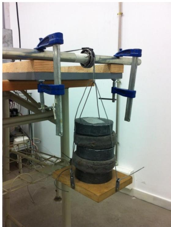
**Ilustración 24. Polea del sistema de calibración**
