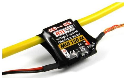
Ilustración 21. Sensor de tensión e intensidad MUI 150 EX
