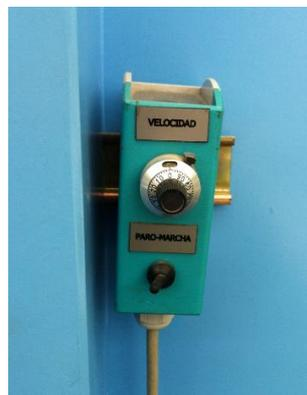
Ilustración 49. Dispositivo de control de la velocidad
