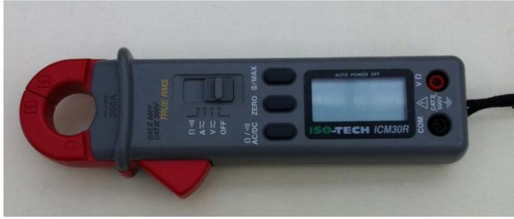
Ilustración 32. Medidor de tensión e intensidad
