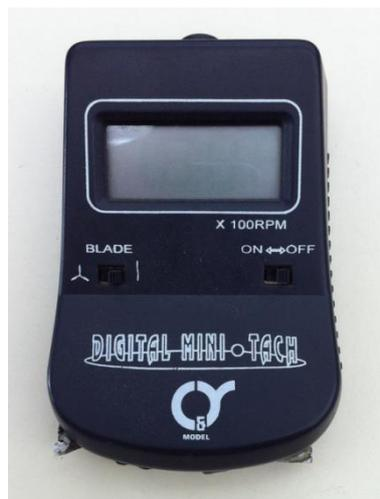
Ilustración 31. Medidor de revoluciones
