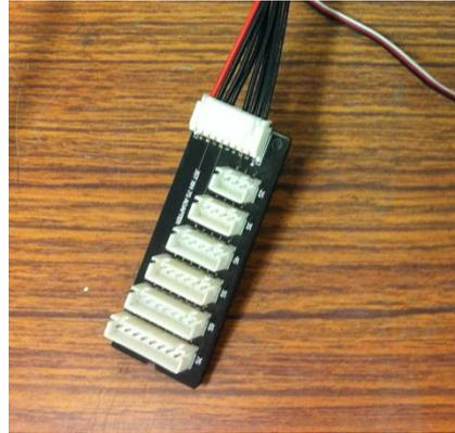
Ilustración 148. Conexión de cables de balanceado de las baterías
