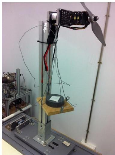
**Ilustración 26. Calibración del par**
