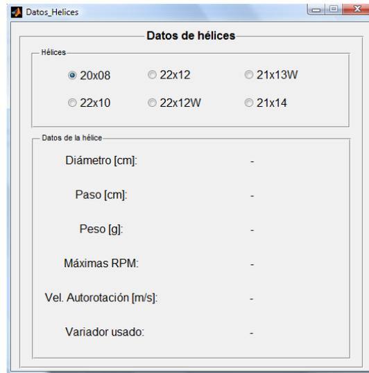
Ilustración 57. Herramienta DATEPS: Módulo de datos de las hélices
