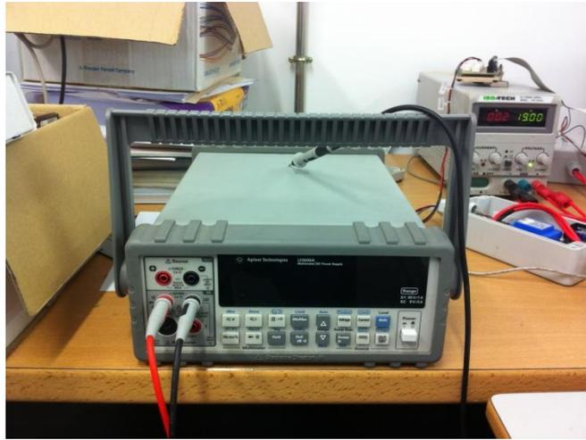
Ilustración 129. Polímetro de precisión
