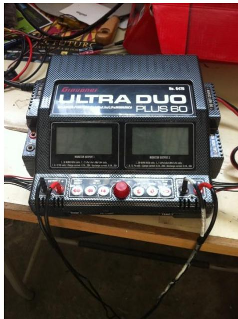
Ilustración 149. Cargador universal de baterías
