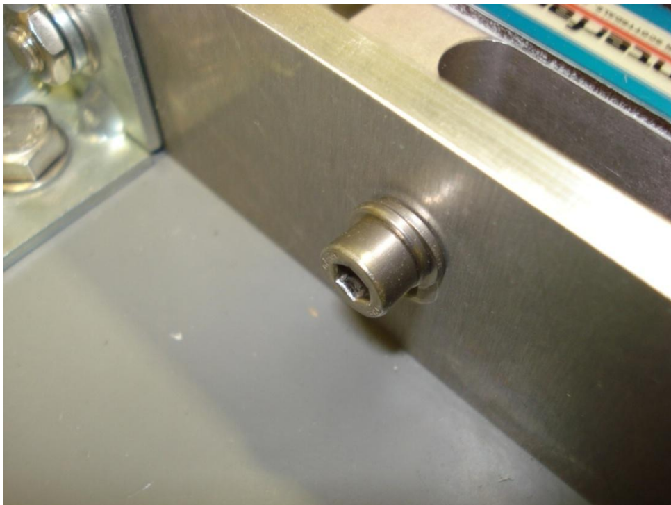
Figura 92 Unión de la célula de carga con la placa 1
