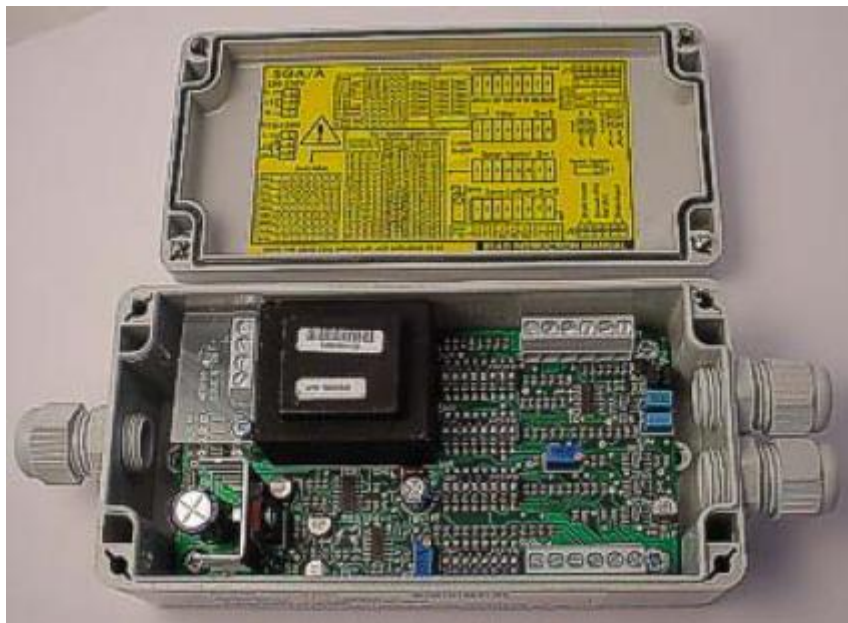
Figura 97 Acondicionador de señal
