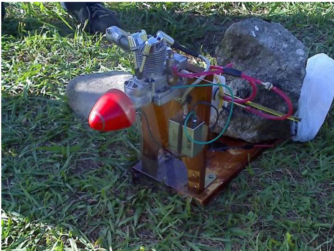
Figura 13 Bancada estática para medir revoluciones (5)
