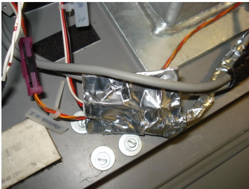
Figura 117 Apantallamiento del chip de sensor Hall
