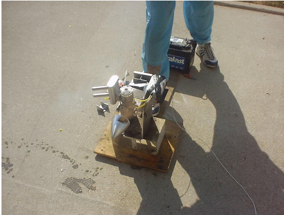
Figura 12 Bancada estática para medir tracción (4)
