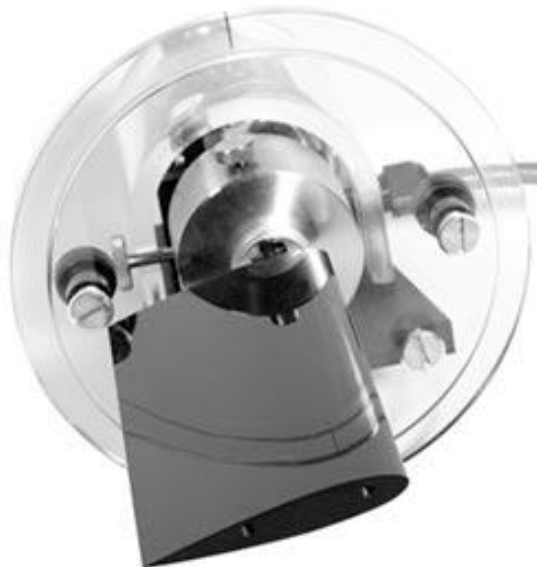
Figura 14 Balanza de tres grados de libertad (6)
