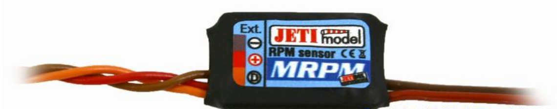
Figura 107 Dispositivo MRPM de sensor de velocidad
