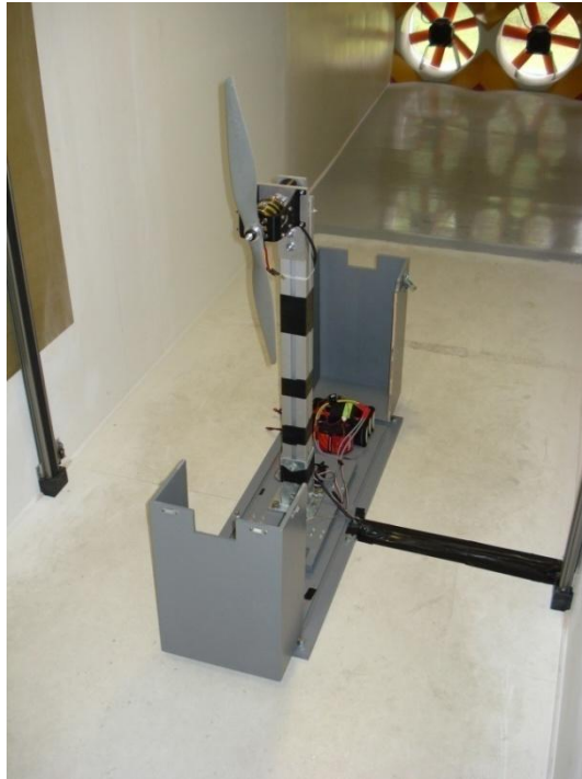
Figura 51 Bancada túnel con carcasas abiertas
