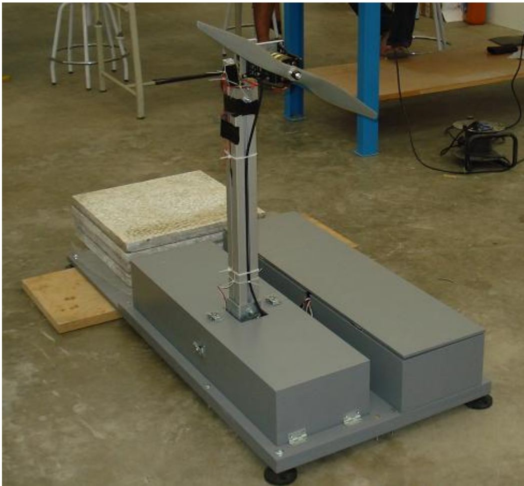
Figura 23 Bancada en conf. para ensayos estáticos
