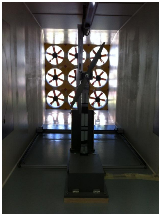
Ilustración 26 Detalle de la bancada instalada en el túnel de viento
