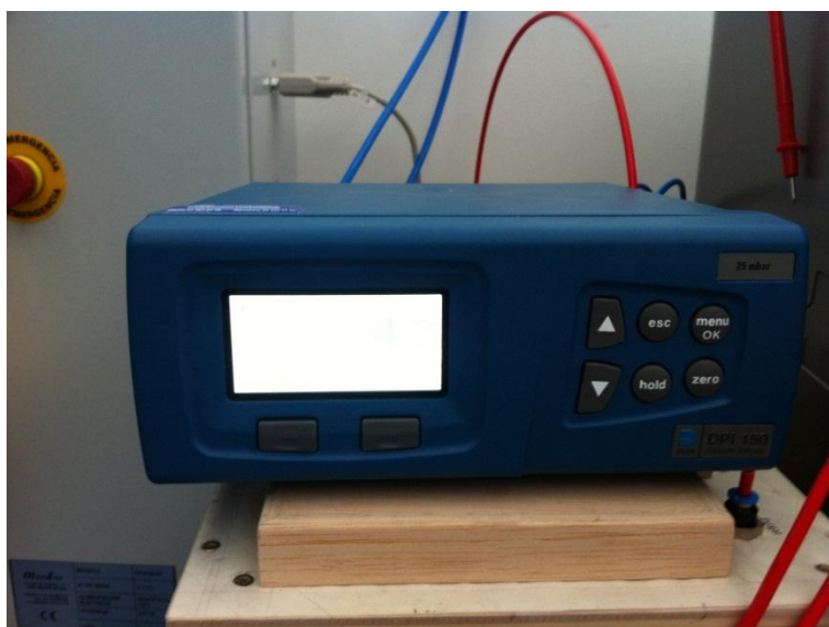
Ilustración 31 Aparato de medida y tratamiento de los parámetros del túnel de viento
