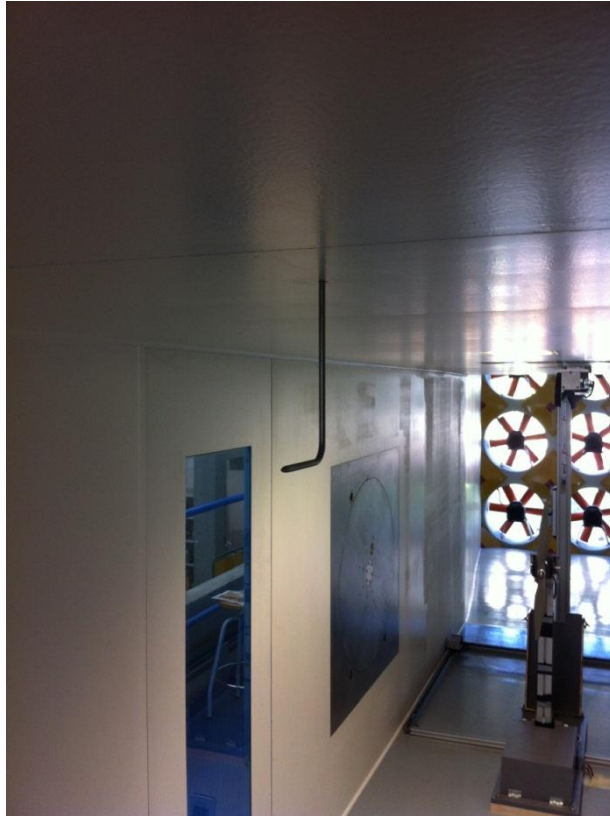
Ilustración 30 Detalle del tubo de pitot instalado en el túnel de viento
