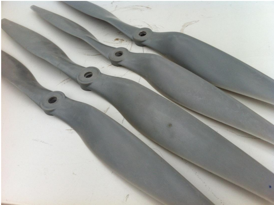
Ilustración 5 Hélices ensayadas (de izquierda a derecha 22x10, 22x12E, 21x14 y 22x12W)
