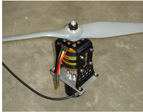
Figura 11 Motor desconectado para medida de resistencia interna
