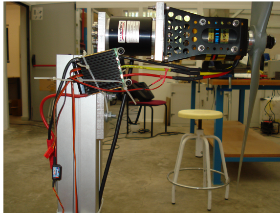
Figura 98 Detalle de la cogida del motor en la bancada
