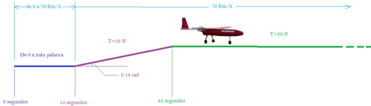
Figura 4.2: Esquema del ensayo de autonomía
