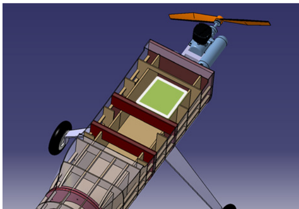
Figura 4.6. - Diseño ubicación tanque de combustible
