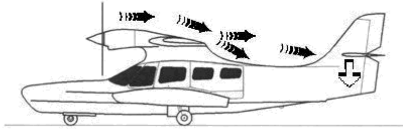
Figura 4.41. - Efecto del motor en la deflexión de estela
