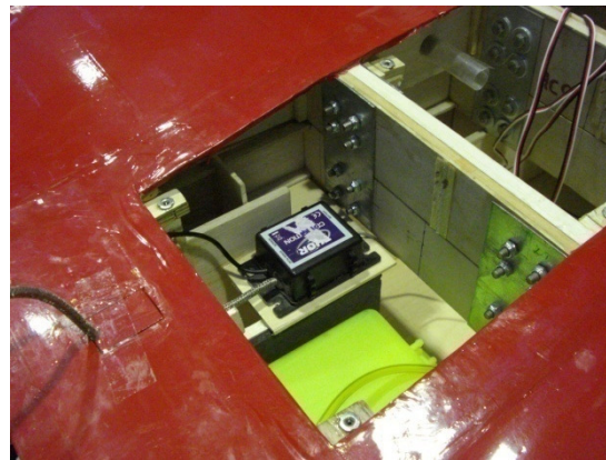
Figura 4.7. - Ubicación real del tanque de combustible
