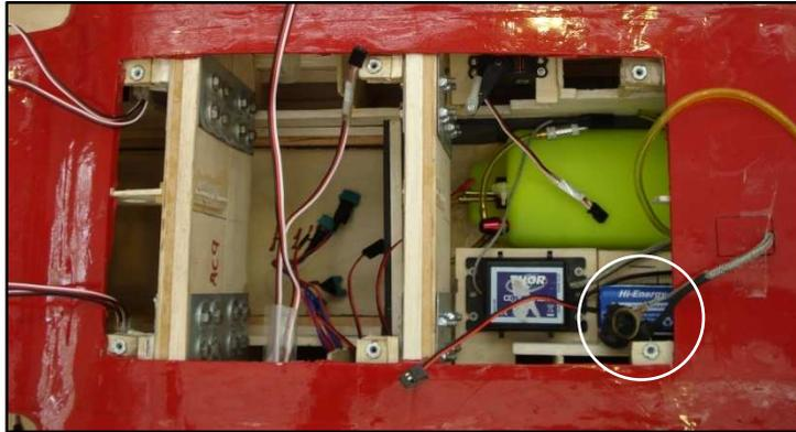
Imagen 8.9: Posición de la batería de motor. Fuente: Elaboración propia
