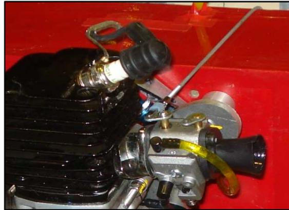
Imagen 8.1 (izquierda): Instalación de servo y varilla de mando de motor. Imagen 8.2 (derecha): Enganche de la varilla de mando de motor con la palometa del carburador. Fuente: Elaboración propia
