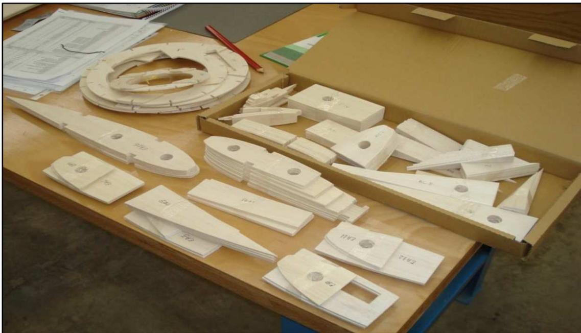
Imagen 6.93: Algunos componentes de madera de balsa de 1/8" preparados para su montaje. Fuente: Elaboración propia
