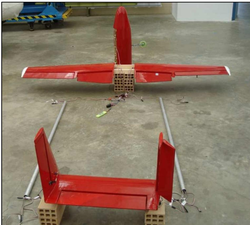
Imagen 9.1: Prueba Funcional del sistema de mandos de vuelo del UAV Céfiro.
