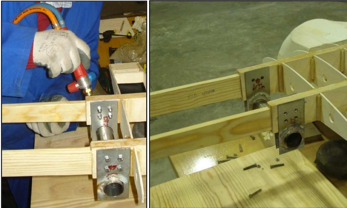
Imagen 13.35 (izquierda): Soldando la cogida para los tubos de cola / Imagen 13.36 (derecha): Conjunto soldado.
