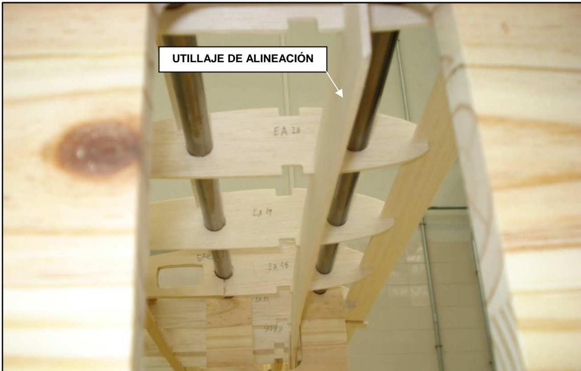
Imagen 6.86: Proceso de alineación de las costillas de Extremo de Ala mediante utillaje. Fuente: Elaboración propia
