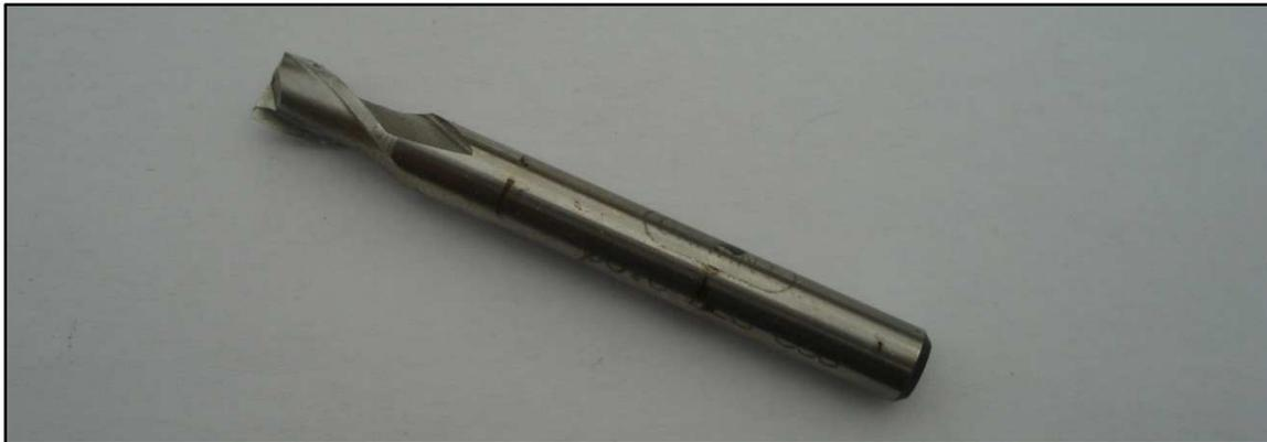
Imagen 6.45: Fresa Garant de  $\Phi 6$ mm. Fuente: Elaboración propia
