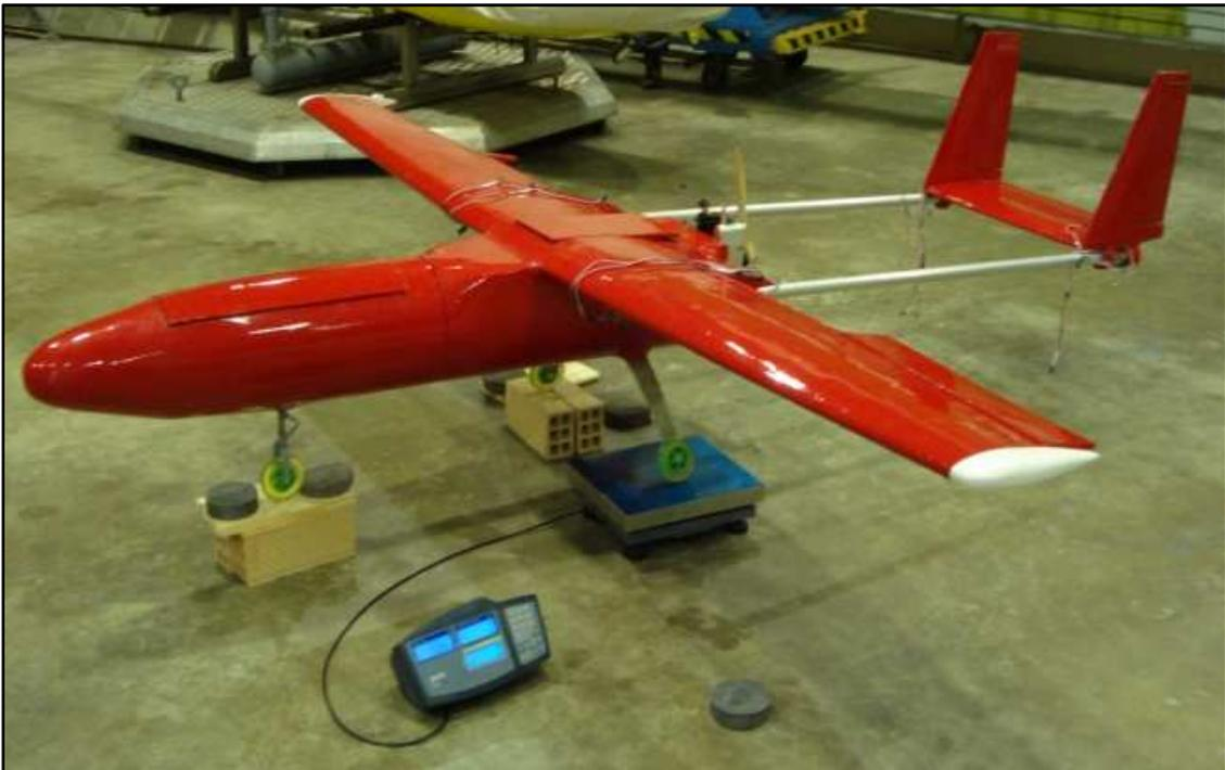
Imagen 9.10: Prueba funcional de pesaje, Báscula bajo rueda izquierda de Tren Principal. Fuente: Elaboración propia
