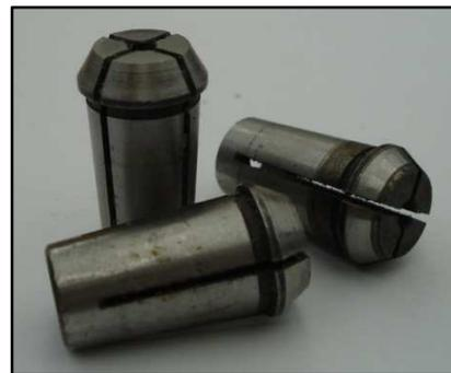
Imagen 6.4 (izquierda): Motor de fresado / Imagen 6.5 (derecha): Juego de pinzas de amarre de herramienta. Fuente: Elaboración propia
