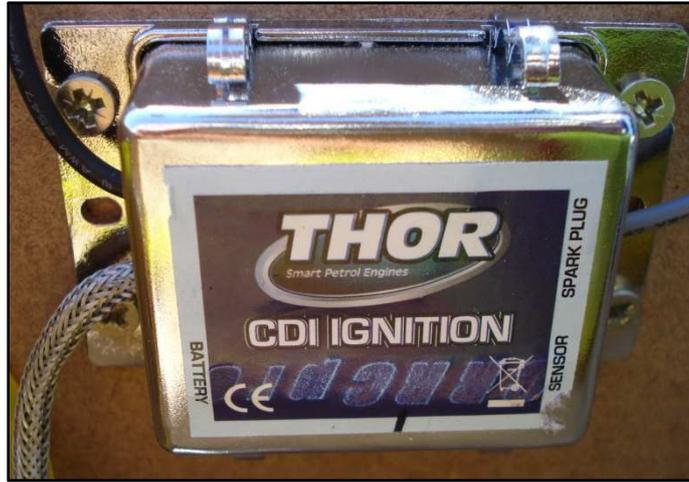
Imagen 7.2: Módulo de ignición electrónica. Fuente: Elaboración propia
