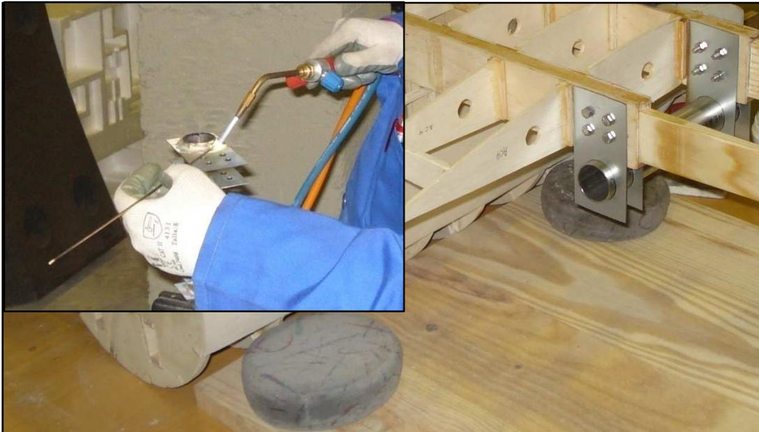
Imagen 13.33 (superior izquierda): Fundiendo el metal de aporte en forma de varilla mediante llama / Imagen 13.34: Cogida subalar del Tubo de Cola previa soldadura (zona superior derecha de la imagen). Fuente: Elaboración propia
