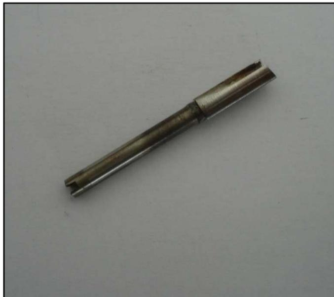
Imagen 6.51 (derecha): Fresa de rebordear de acero rápido, para corte de madera, de  $\Phi 5\text{mm}$ .
