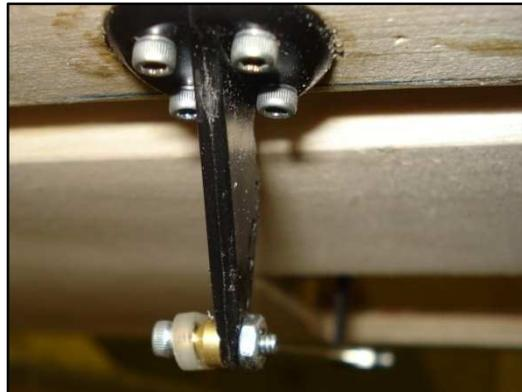
Imagen 8.3 (izquierda): Instalación varilla de mando - servo. Imagen 8.4 (derecha): Instalación varilla de mando - escuadra de mando. Fuente: elaboración propia
