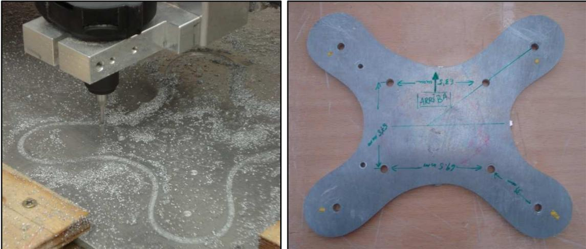
Imagen 6.114 (izquierda): Proceso de corte de la placa de cogida de motor / Imagen 6.115 (derecha): Placa ya cortada.
