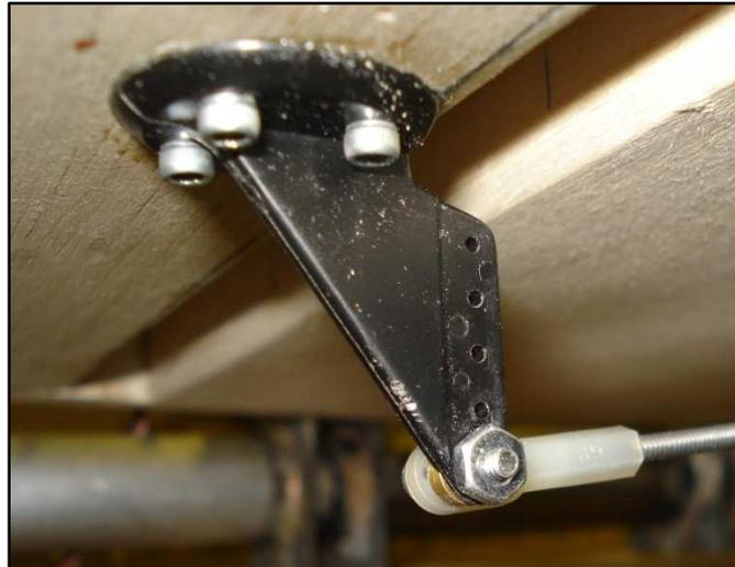
Imagen 7.26 (izquierda): Detalle de montaje de una escuadra de mando. Fuente: Elaboración propia.
