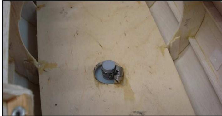
Imagen 13.27 (izquierda): Presilla de acero. Imagen 13.28 (derecha): Sujeción del tren de morro mediante presilla. Fuente: Elaboración propia
