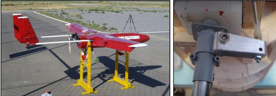
Imagen 9.6 (izquierda): Soportes para elevar el avión / Imagen 9.7 (derecha): Cogida varilla de mando - Tren Auxiliar
