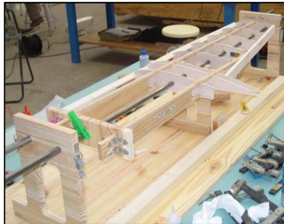
Imagen 6.126 (izquierda): Estructura de montaje del Extremo de Ala / Imagen 6.127 (derecha): Proceso de montaje del Extremo de Ala. Fuente: Elaboración propia
