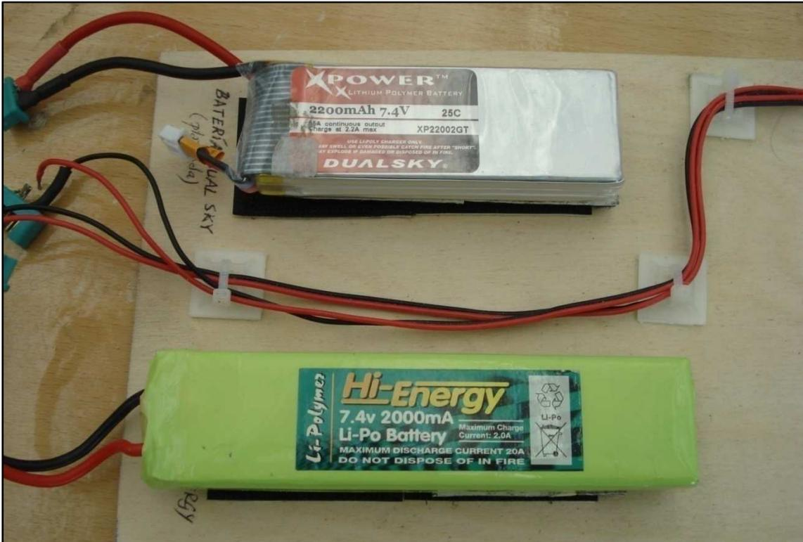
Imagen 7.25: Batería de LiPo de 2200mAh (parte superior de la imagen). Batería LiPo 2000mAh (parte inferior de la imagen). Fuente: Elaboración propia
