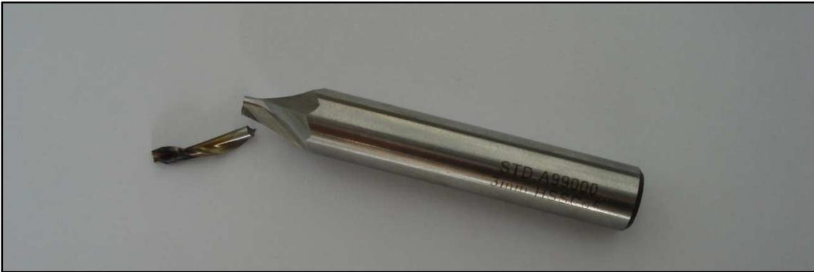
Imagen 6.48: Rotura de una fresa de acero rápido de  $\Phi 3$ mm durante el corte de contrachapado.
