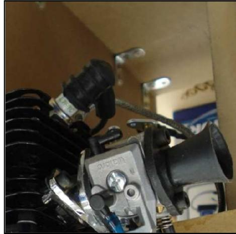
Imagen 8.10 (izquierda): Eje de transmisión desmontado / Imagen 8.11 (derecha): Colocación de la bujía en la cabeza del cilindro. Fuente: Elaboración propia
