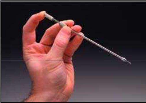
La primera herramienta de este grupo, que se muestra en la imagen 6.11, se emplea para determinar la posición de los agujeros de montaje de motor. El manejo consiste en presionar el cono de auto alineación de centrado, de uno de sus extremos, dentro del agujero de montaje con el motor posicionado en su localización. Marcado este punto, girar la herramienta al tiempo que se presiona para que la punta deje una marca bien centrada.
