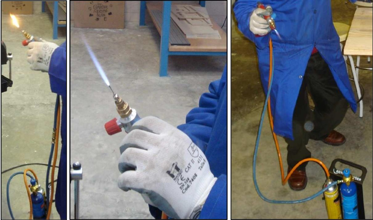
(De izquierda a derecha) Imagen 13.30 y 13.31: Encendido de la pistola y ajuste de la llama / Imagen 13.32: Equipo de soldadura por llama. Fuente: Elaboración propia
