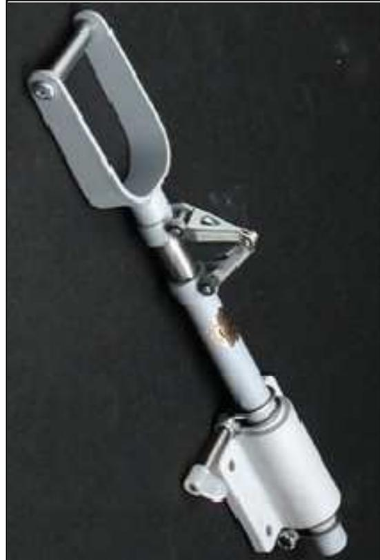
Imagen 7.44 (izquierda): Despiece del tren delantero / Imagen 7.45 (derecha): Tren delantero. Fuente: [9]
