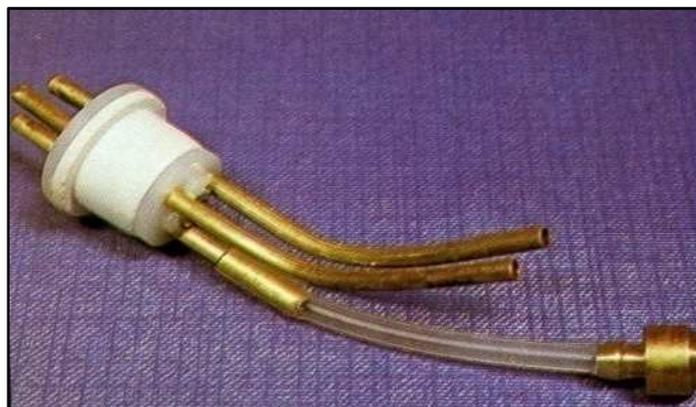
Imagen 8.47: Tapón del tanque de un tanque de combustible.
