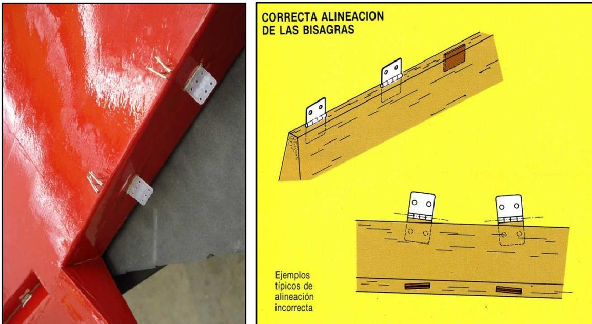
Imagen 7.42: Bisagras para la unión borde de salida – flap. Fuente: Elaboración propia
