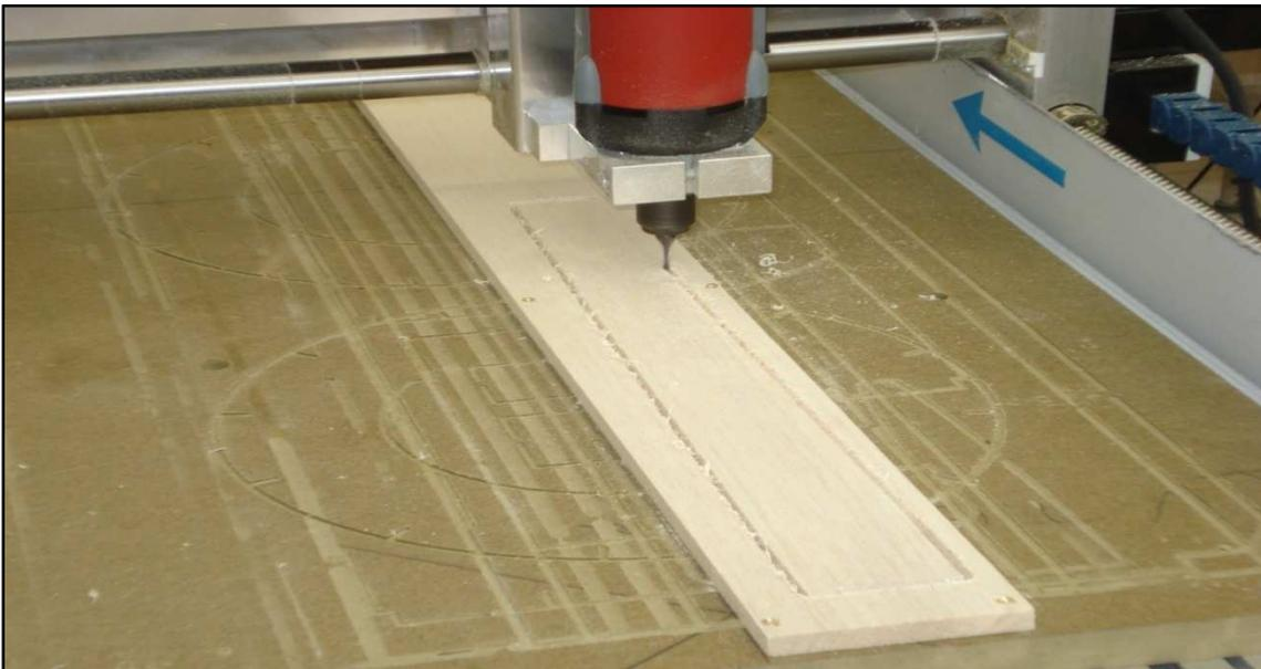
Imagen 6.98: Corte CNC de la plantilla 1 del Extremo de Ala en balsa de espesor 3/8". Fuente: Elaboración propia
