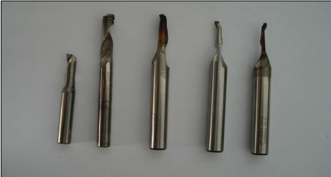
Imagen 6.49: Herramientas de acero rápido empleadas (de izquierda a derecha: Fresa de  $\Phi 6\text{mm}$  con mango de  $\Phi 6\text{mm}$ , Fresa de  $\Phi 6\text{mm}$  con mango de  $\Phi 6\text{mm}$ , Fresa de  $\Phi 6\text{mm}$  con mango de  $\Phi 8\text{mm}$ , Fresa de  $\Phi 4\text{mm}$  con mango de  $\Phi 8\text{mm}$  y Fresa  $\Phi 3\text{mm}$  con mango de  $\Phi 8\text{mm}$ ). Fuente: Elaboración propia
