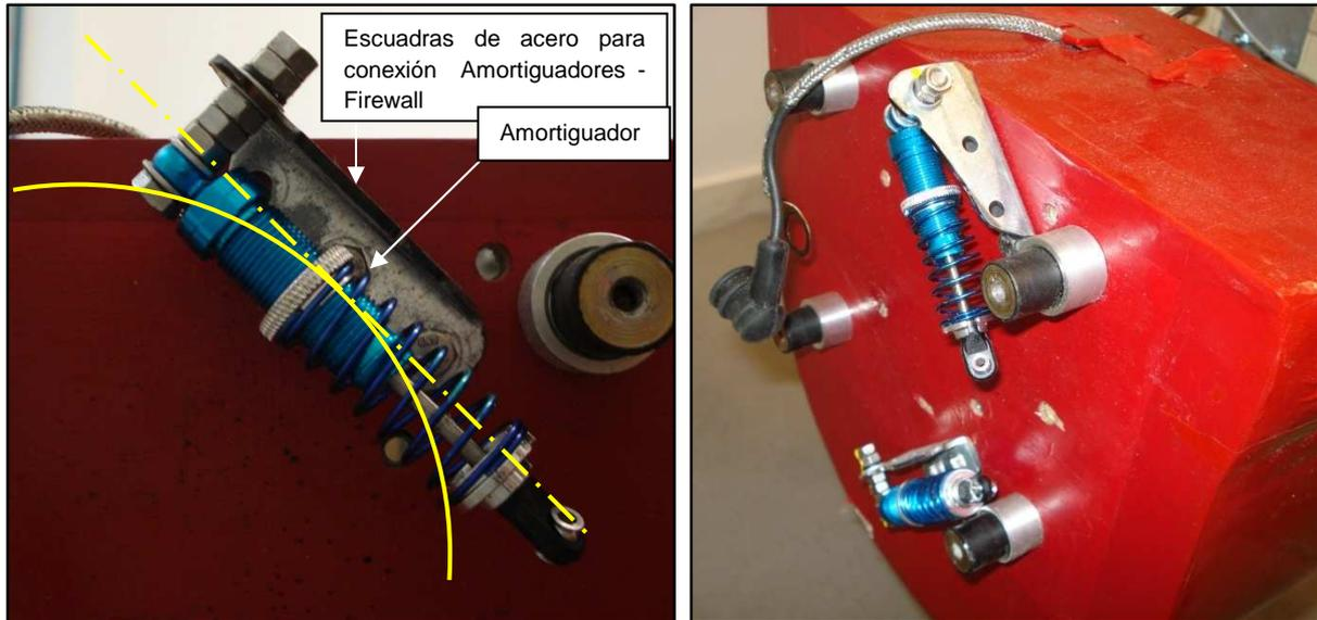
Imagen 8.39 (izquierda): Amortiguador + Escuadra / Imagen 8.40 (derecha): Ubicación de amortiguadores y silent blocks en Firewall. Fuente: Elaboración propia
