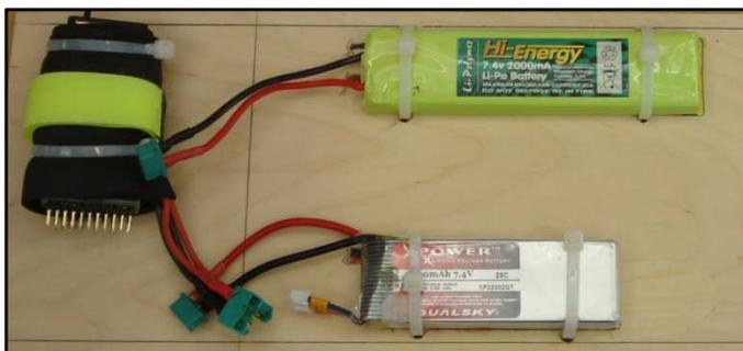
Imagen 13.42 (izquierda): Baterías y receptor unidos mediante velcro, y asegurados a través de bridas convencionales, a una tabla de contrachapado. Fuente: Elaboración propia
