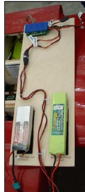
Imagen 8.7 (izquierda): Sistema de bandeja extraíble mediante guías acolchadas. Imagen 8.8 (derecha): Disposición de elementos (baterías de LiPo y regulador de tensión) en la bandeja. Fuente: Elaboración propia
