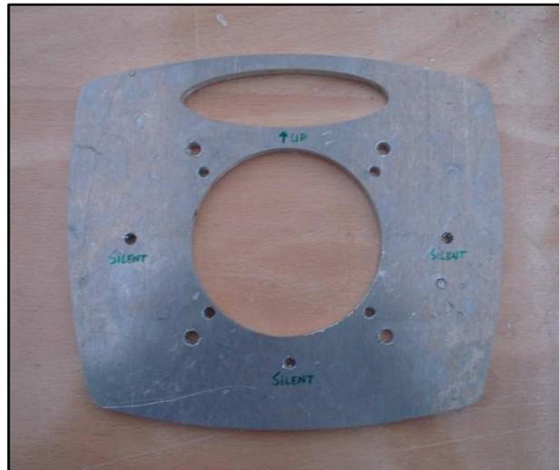
Imagen 12.3: Nueva placa de cogida para motor. Fuente: CATIA V5.
