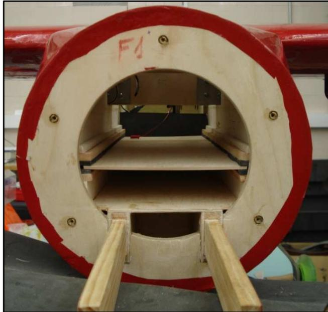
Imagen 13.26 (izquierda): Insertos roscados en la unión Morro - Fuselaje. Fuente: Elaboración propia
