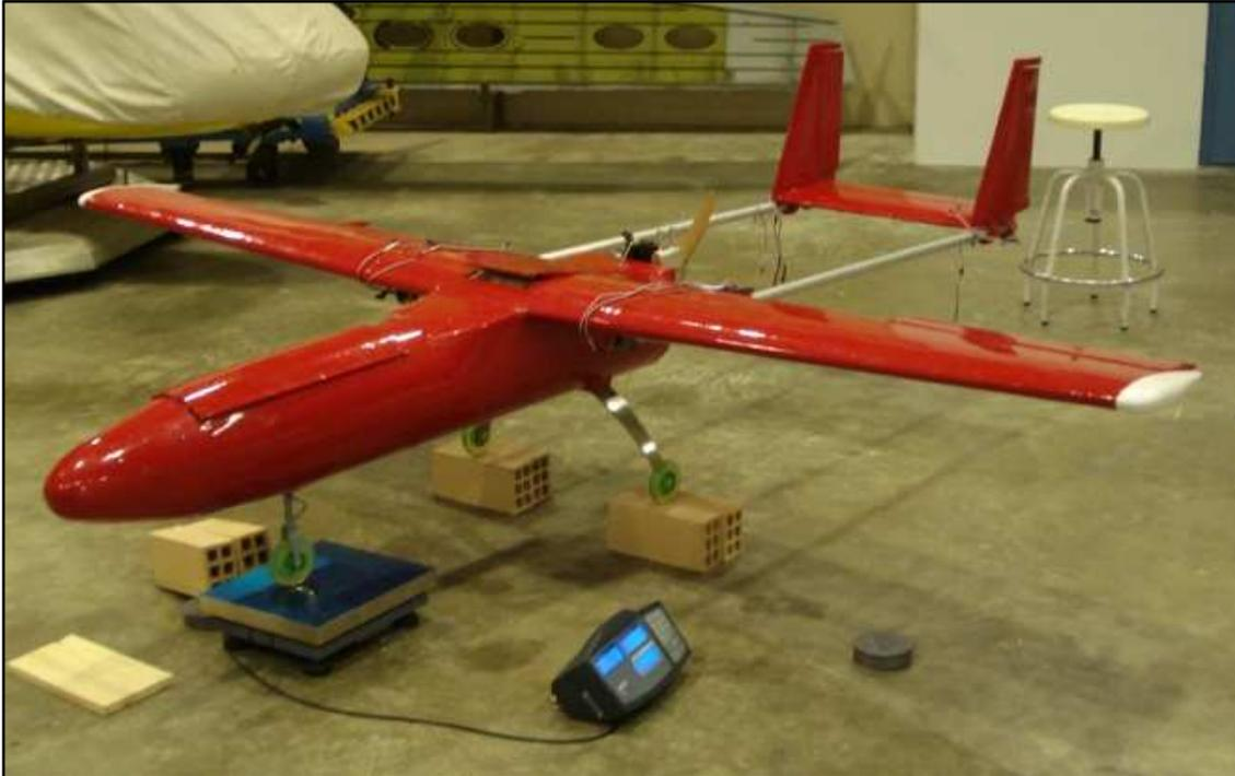
Imagen 9.9: Prueba Funcional de pesaje. Báscula bajo rueda de Tren Auxiliar. Fuente: Elaboración propia
