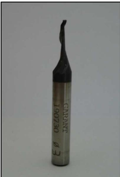
Imagen 6.50 (izquierda) Fresa de acero rápido con recubrimiento, de  $\Phi 3\text{mm}$  con mango de  $\Phi 6\text{mm}$ .
