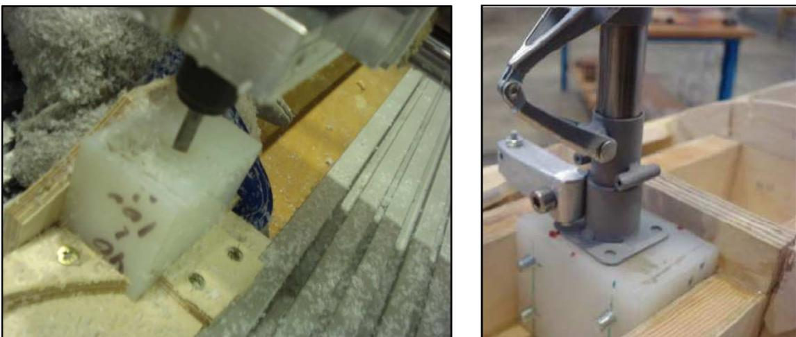
Imagen 6.116 (izquierda): Proceso de corte del bloque de sujeción del tren auxiliar / Imagen 6.117 (derecha): Bloque de nylon para cogida de tren auxiliar terminado e integrado en la estructura de Morro. Fuente: Elaboración propia
