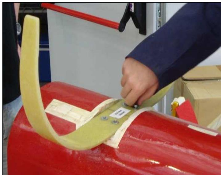
Imagen 7.46: Atornillado del Tren principal al fuselaje.
