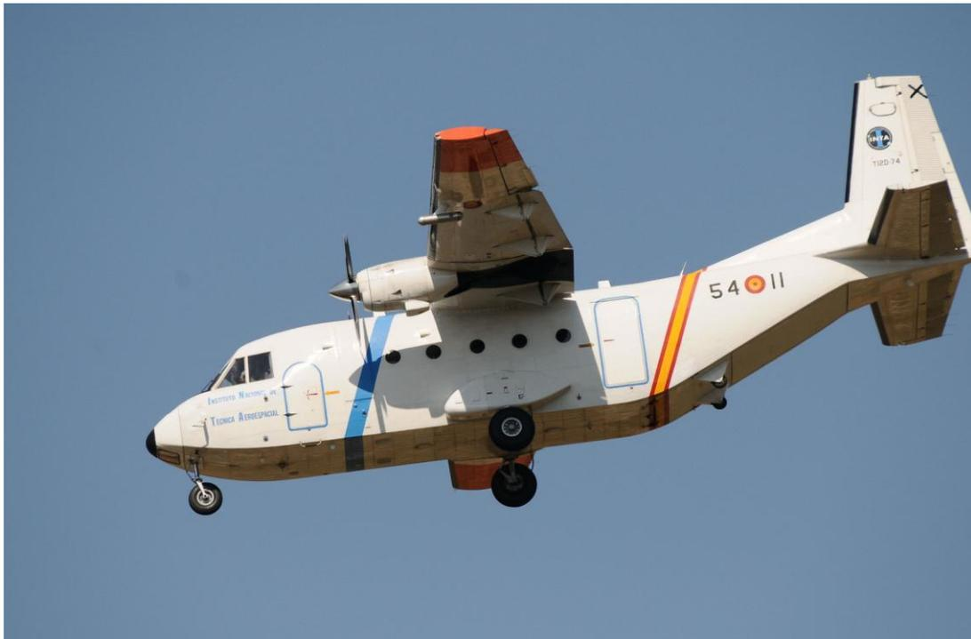
Fig. 4.1. Fuselaje de sección transversal rectangular del INTA
