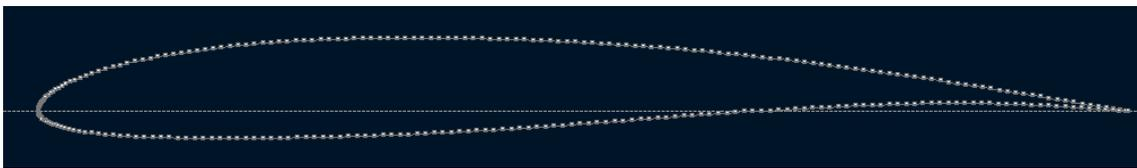
Fig. 2.22. PERFIL 1, 300 puntos de control
