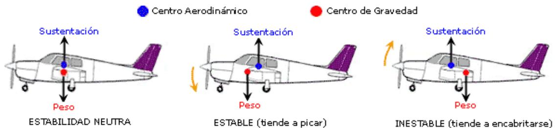
Fig. 2.11. Estabilidad longitudinal (<http://www.manualvuelo.com>)
