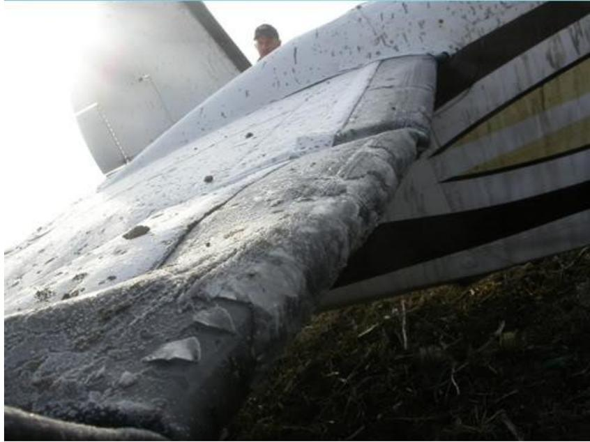
Fig. 2.6. Acumulación de hielo claro en el borde de ataque (<http://www.x-plane.es>)
