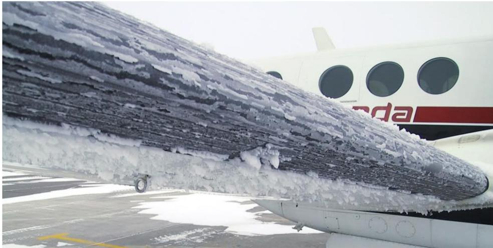
Fig. 2.4. Acumulación de hielo granular en el borde de ataque pese al sistema antihielo
