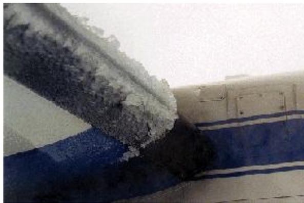
Fig. 2.5. Acumulación de hielo granular en el borde de ataque sin sistema antihielo
